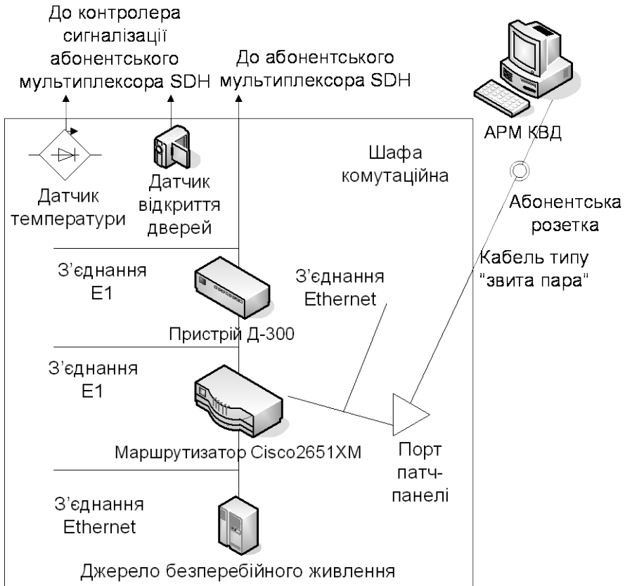
Рис. 5.52. Загальна схема з'єднань абонентського пункту СІТС
