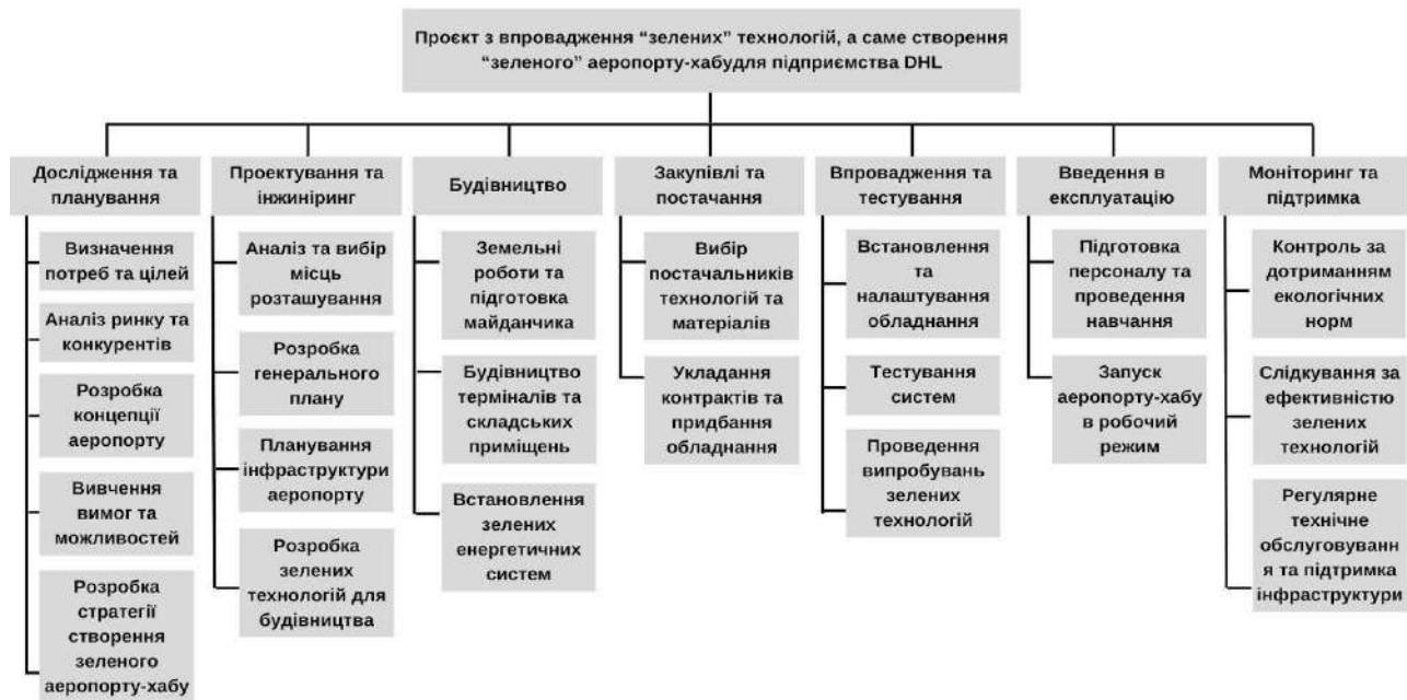
Рис.1. Ієрархічна структура робіт (WBS) проекту створення "зеленого" аеропорту - хабу для провідного логістичного провайдера – компанії DHL
