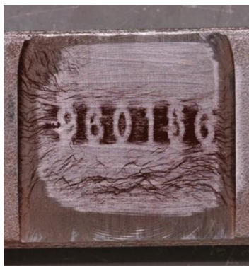
Фото 3. Маркування виявлене із застосуванням магнітопорошкового методу дефектоскопії
