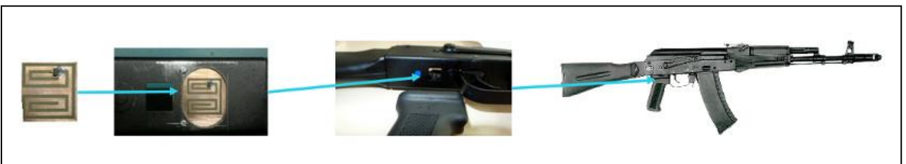
Фото 2. Варіант розміщення RFID-мітки на зброї
