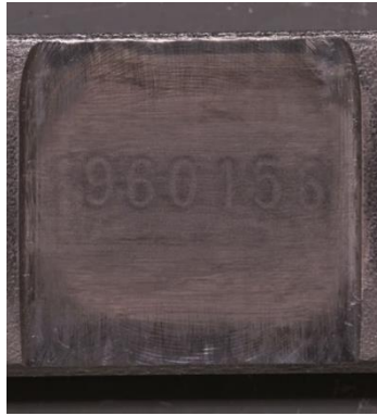
Фото 4. Маркування виявлене із застосуванням електрохімічного методу
