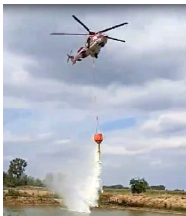
Рис. 1.12. Вертоліт EC-H225 LP з ВЗП на зовнішній підвісці
