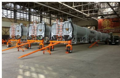
Рис. 1.24. Внутрішньо-фюзеляжний водозливний авіаційний пристрій літака Іл-76 МТД
