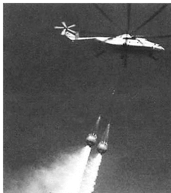
Рис. 1.31. Водозливний модуль ЄП-8000 вертольоту Мі-6ПЖ2
