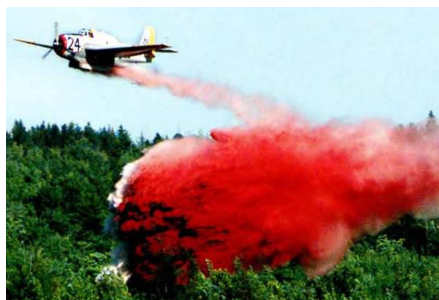
Рис. 1.17. Модернізований у пожежний варіант літак TBM Avenger
