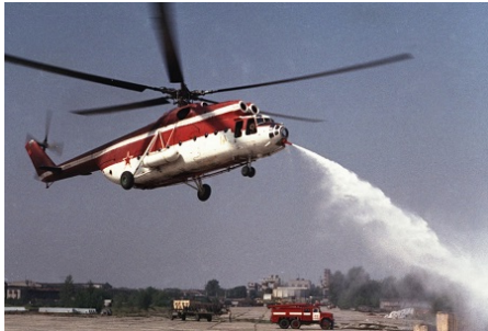
Рис. 1.30. Пожежний вертоліт Мі-6ПЖ2 з водометною гарматою
